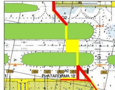
Este caminho apresenta sinais semáforos embutidos no pavimento operando H24 via ADS-B em função da distância a que o objeto seguido (as aeronaves por ADS-B se encontra do semáforo).
