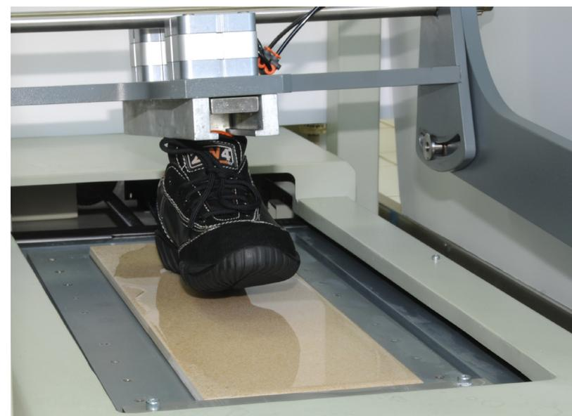
**Figura 6.** Método de ensaio de determinação da resistência ao escorregamento do calçado.
