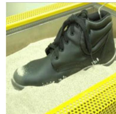
Figura 11. Determinação do isolamento ao calor.
